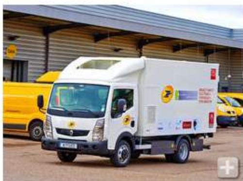
L'hydrogène est quasiment absent du marché français si l'on exclut les quelques expérimentations faites par certains constructeurs. C'est notamment le cas de [Renault](#) qui lance par le biais de sa division camions « [Trucks](#) » le Maxity à prolongateur d'autonomie avec pile à combustible.
