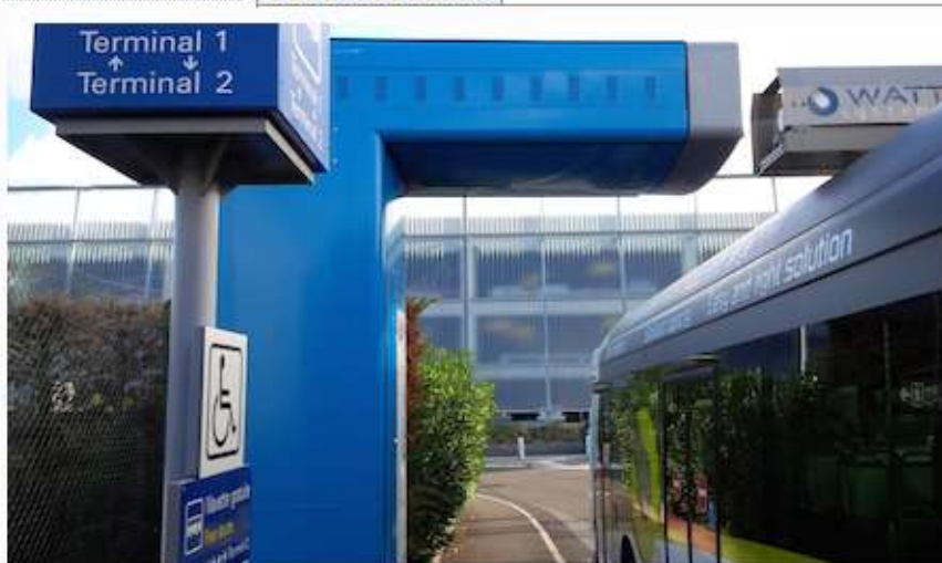
Le biberonnage du véhicule consiste à effectuer un transfert d'énergie depuis le poteau d'arrêt (Totem) vers le véhicule pendant le temps d'échange de passagers.
