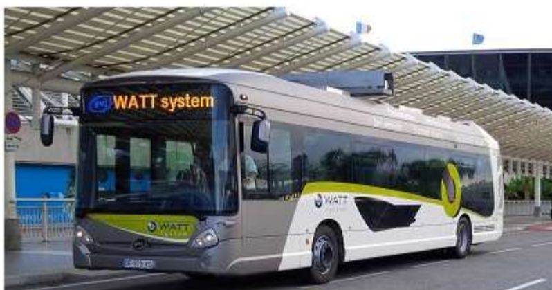
Le bus de 12 m de PVI est un Heuliez Bus dont la partie arrière et le pavillon ont été complètement réaménagés pour rouler à l'électricité (photo X D.R.).
