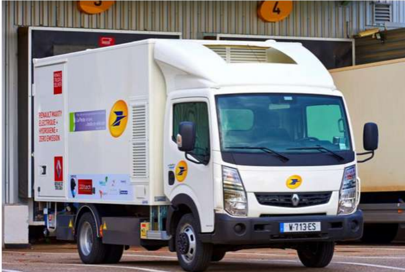
Frente al Maxity Eléctrico de serie, esta unidad duplica la autonomía hasta los 200 km.
